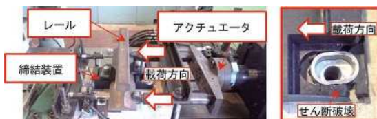
図9 横圧強度試験の破壊状況 (FRTP)
